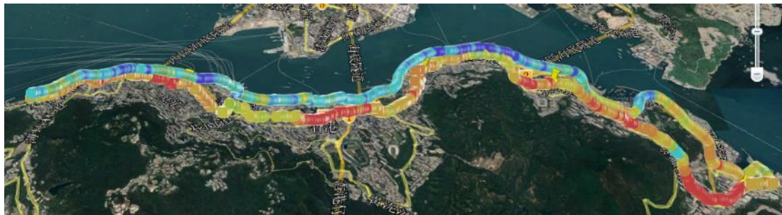
图 6.46 港岛东西走廊及内部道路 DTMB-A Mobile1 模式下的信号强度强度情况（-55 ~ -90dBm）
