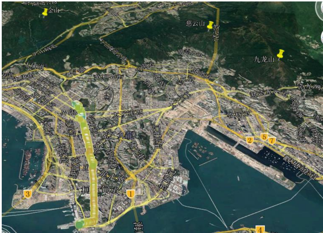
图 6.56 弥敦道 DTMB-A Mobile2 模式下的信号强度强度情况（-60 ~ -78dBm）
