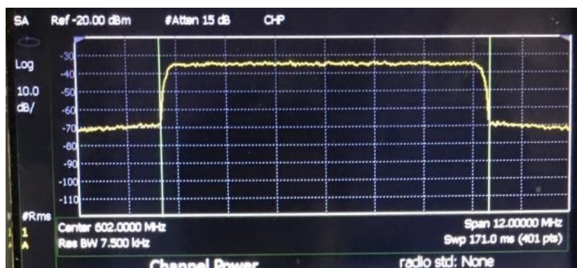
图 4.6 飞鹅山 DTMB-A 激励器非线性校正前的信号频谱和带肩
