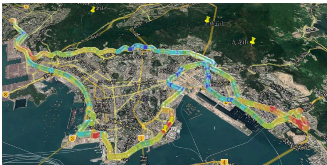
图 6.50 九龙岛环线 DTMB-A Mobile1 模式下的信号强度强度情况（-55 ~ -90dBm）
