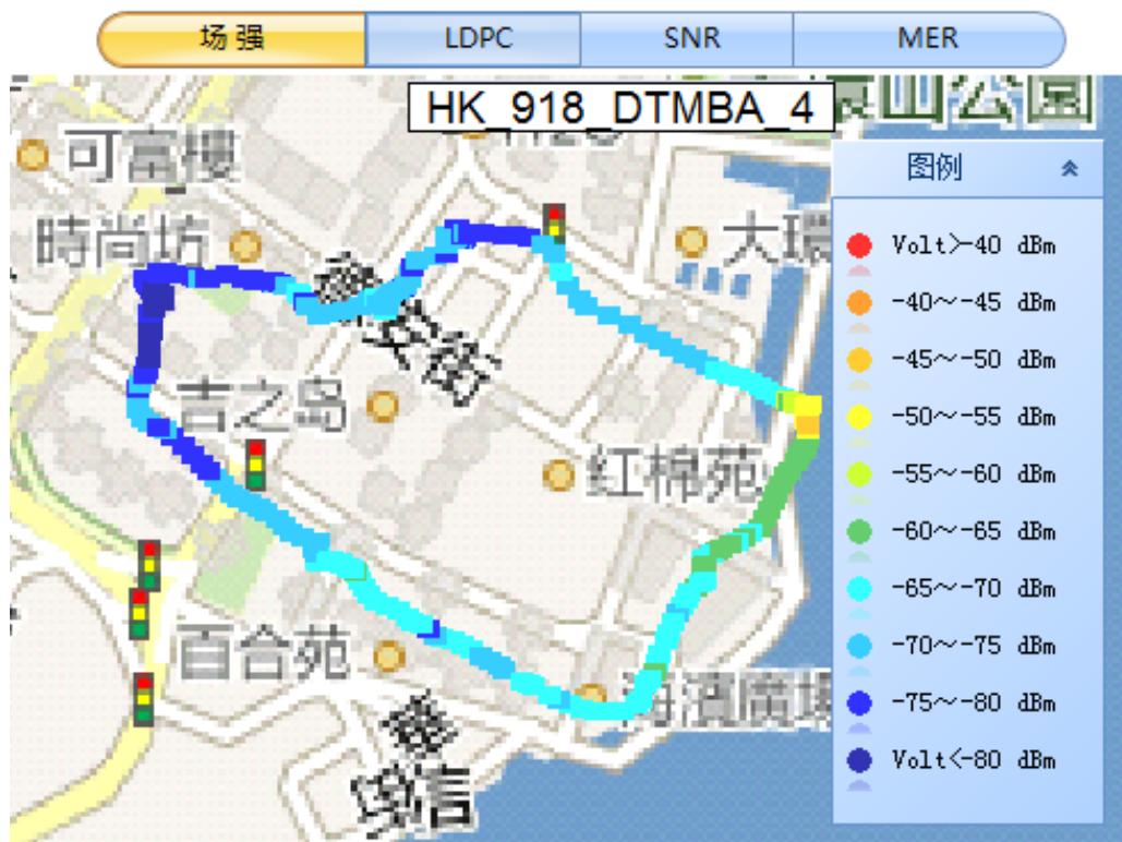
图 6.53 黄埔花园 DTMB-A 系统移动测试接收电平情况
