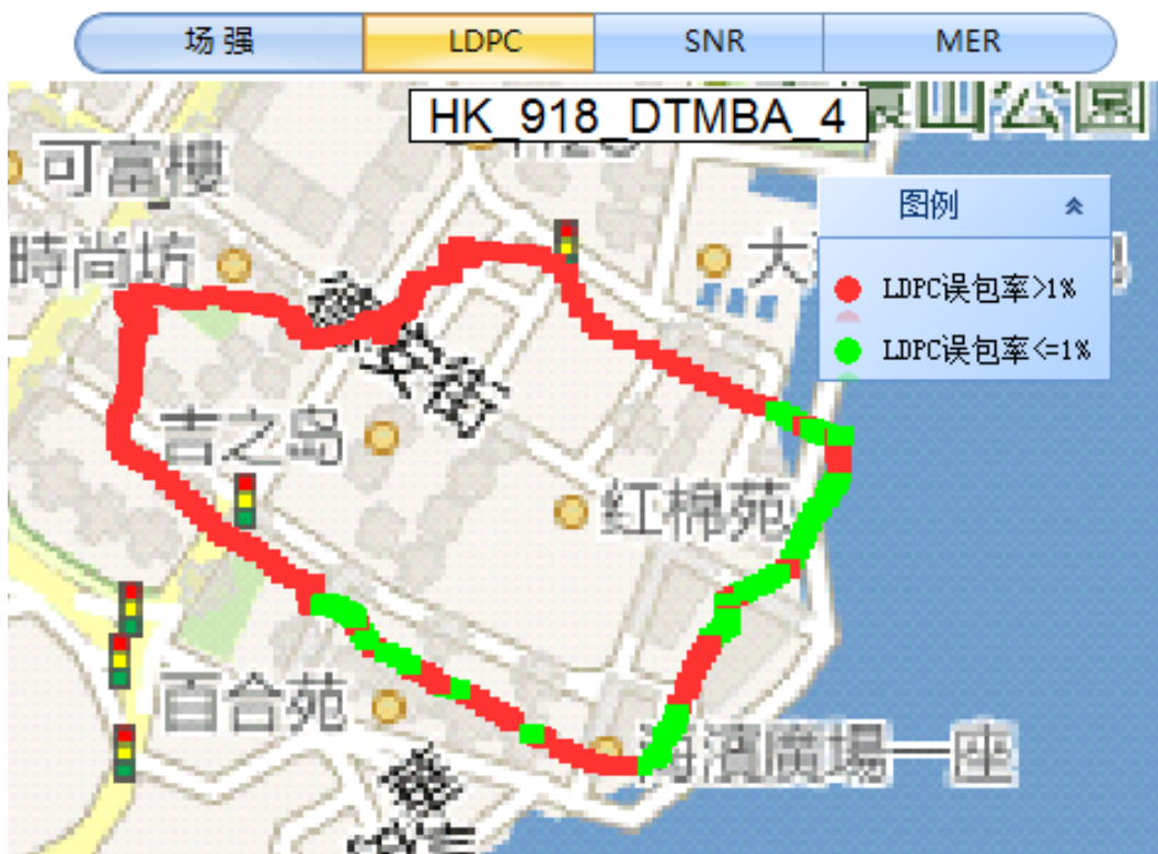
图 6.55 黄埔花园 DTMB-A 系统移动测试误码情况
