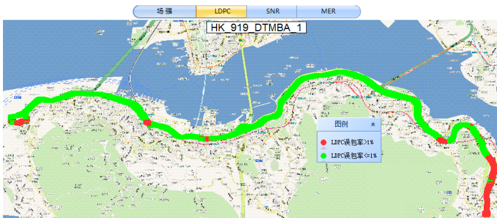
图 6.47 港岛东西走廊 DTMB-A 系统移动测试误码情况
