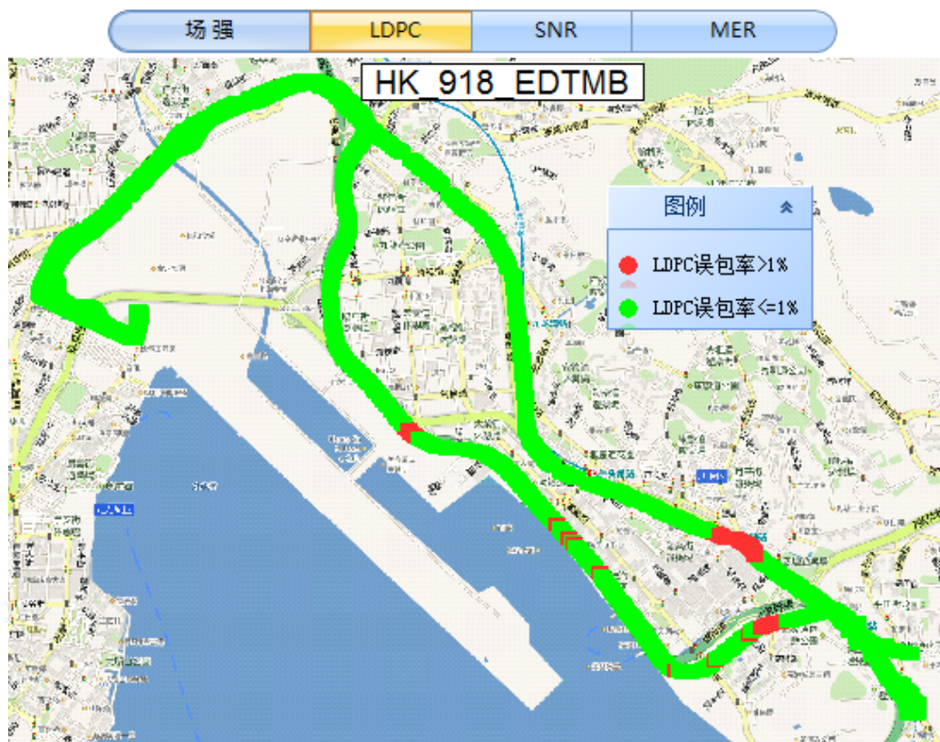
图 6.63 启德机场至蓝田 E-DTMB 误码情况
