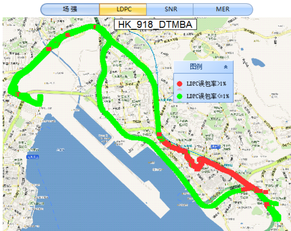
图 6.65 启德机场至蓝田 DTMB-A 系统移动测试误码情况
