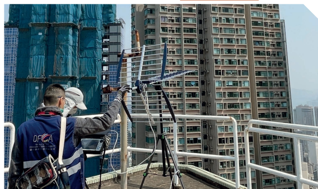
通訊辦職員在樓宇天台進行實地測量，以協助居民解決電視訊號接收問題。
