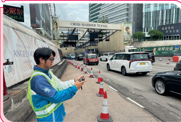
通訊辦職員在檢測行車隧道轉播的無線電訊號與聲音廣播訊號的兼容性。
