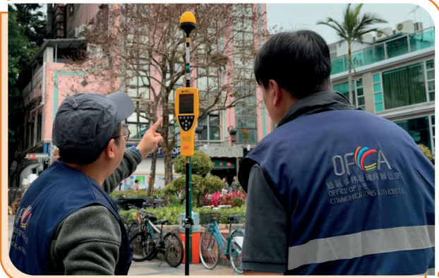
通訊辦職員正在為基站附近的居民進行非電離輻射水平測量。
